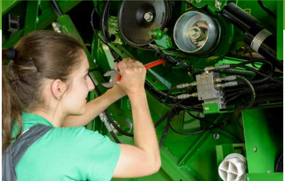
Réglage de la tension d'une courroie de transmission d'une presse à balles.
